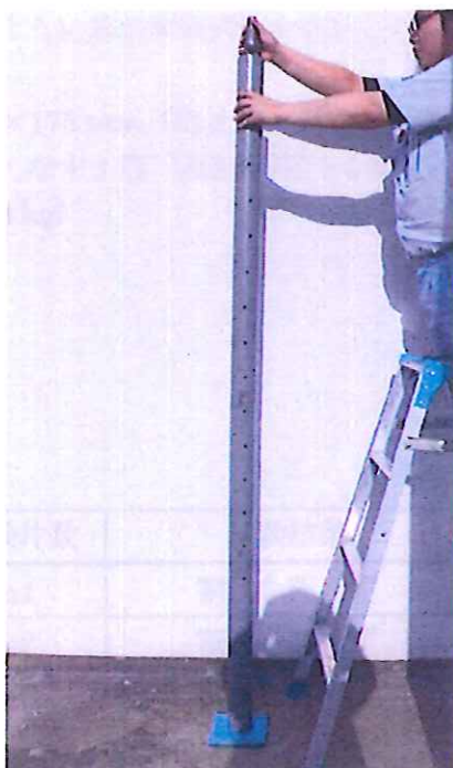
写真2 落球衝撃試験状況
