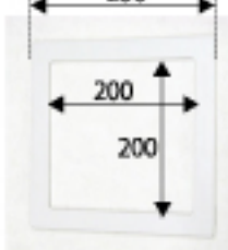
外枠取付後寸法
